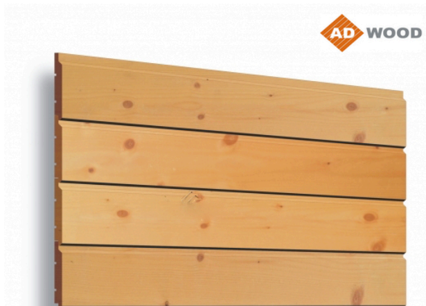
Profilis: DP (lygios su tarpu), 19 x 145 x 6000, A/B klasė, šiaurinė eglė, obliuotas paviršius.
